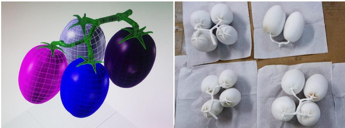
Figura 04 - Digitalização de tomates em cacho (acima) e reprodução de cachos de tomates por meio de impressão 3D
