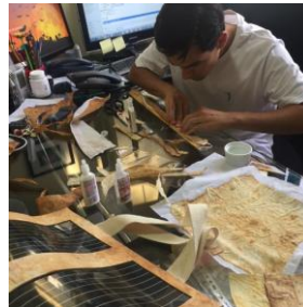
Figura 10: Testes com cola de mandioca. Fonte: elaborada pelos autores
