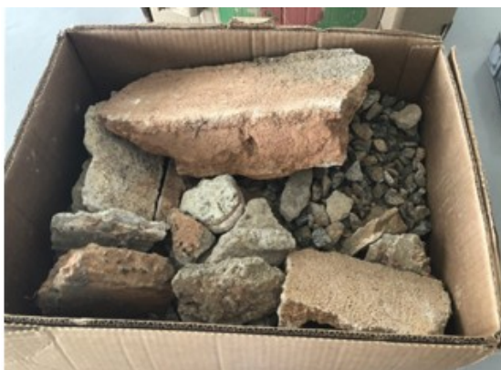
Figura 1: Amostra de resíduos de construção e demolição utilizada no estudo. Fonte: elaborado pelos autores, 2018.
