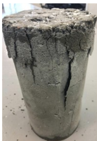
Figura 4: Corpo-de-prova de 7 dias com fratura do tipo G. Fonte: elaborado pelos autores, 2018.
