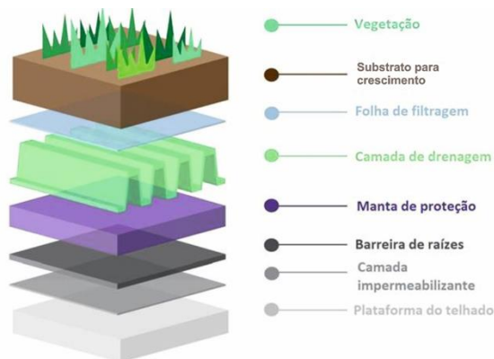
Figura 1: Desenho esquemático da composição das camadas do telhado verde em geral. Fonte: http://sb11.com.br/telhadoverde
