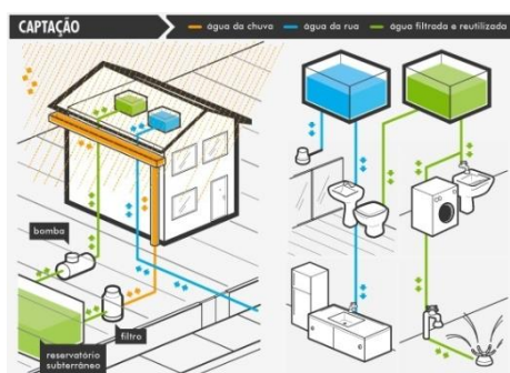
Figura 1: Sistema de Captação. Fonte: (RODRIGUES, 2010)
