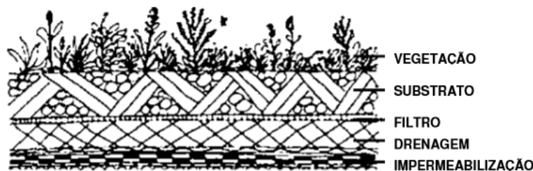
Figura 1: Camadas em uma cobertura verde (Fonte: TANNER e SCHOLZ-BARTH, 2004)
