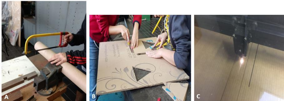
Figura 5: Processo de corte do papelão. (A) Corte com serra. (B) Corte com estilete. (C) Corte a laser. Fonte: acervo do autor.
