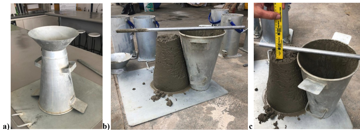
Figura 3: Etapas do ensaio de Slump Test: a) Forma tronco-cônica utilizado no ensaio; b) e c) Leitura do abatimento com auxílio de uma régua. Fonte: elaborado pelos autores, 2018.
