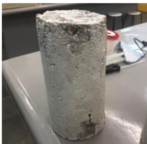
Figura 6: Corpo-de-prova de 21 dias com fratura do tipo F. Fonte: elaborado pelos autores, 2018.
