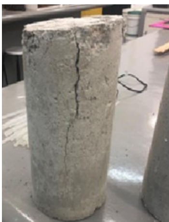
Figura 7: Corpo-de-prova de 21 dias com fratura do tipo Colunar. Fonte: elaborado pelos autores, 2018.
