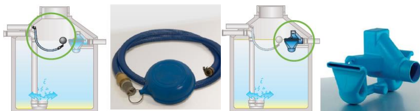
Figura 3: Filtro flutuante de sucção e sifão ladrão. Fonte: (RODRIGUES, 2010; FEAM, 2016)
