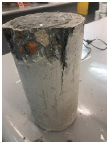
Figura 8: Corpo-de-prova de 28 dias com fratura do tipo B – Cônica e bipartida. Fonte: elaborado pelos autores, 2018.
