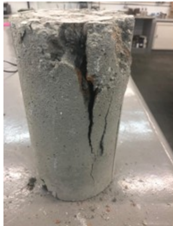
Figura 9: Corpo-de-prova de 28 dias com fratura do tipo B – Cônica e bipartida. Fonte: elaborado pelos autores, 2018.
