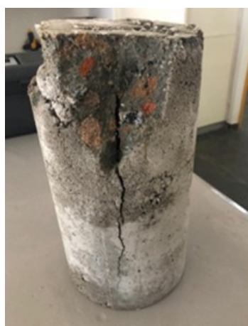
Figura 5: Corpo-de-prova de 7 dias com fratura do tipo B – Cônica e bipartida. Fonte: elaborado pelos autores, 2018.
