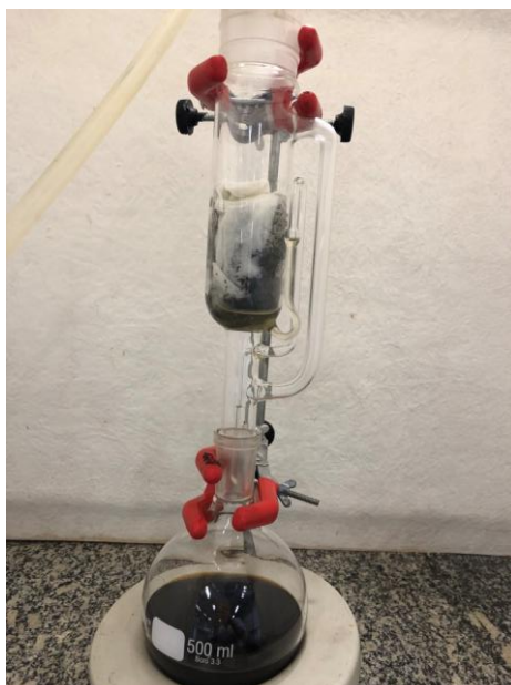
Figura 1: método Soxhlet. Fonte: elaborada pelos autores
