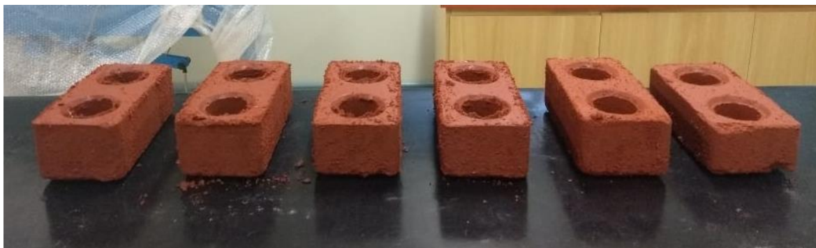
Figura 4: Primeiros blocos produzidos, secando ao ar livre. Fonte: Elaborado pelos autores.
