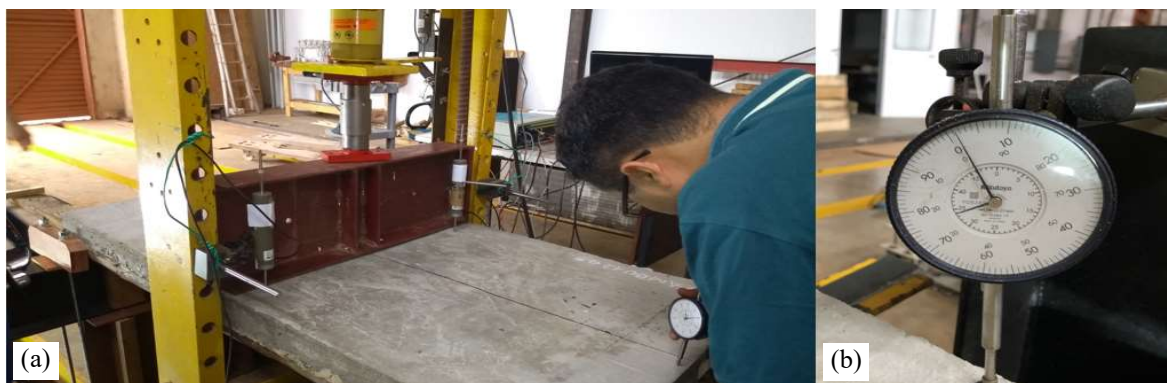
Figura 9a: Preparação dos ensaios e posicionamento dos LVDTs; Figura 9b: Relógio comparador posicionado na região do apoio. Fonte: elaborado pelos autores.
