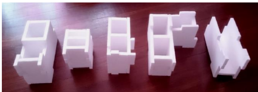
Figura 2. Modelo em escala real feito em poliestireno expandido. Fonte: Elaborado pelos autores
