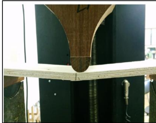
Figura 5: Ensaio do compensado naval à Flexão Estática. Fonte: Leite, 2017.
