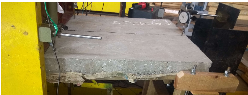
Figura 10: Posicionamento do relógio comparador na região do apoio. Fonte: elaborado pelos autores.
