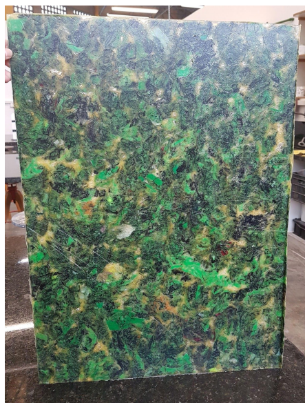
Figura 3: Placa resultante da primeira fase de experimentações nas dimensões 600x450mm. Fonte: elaborado pela autora.
