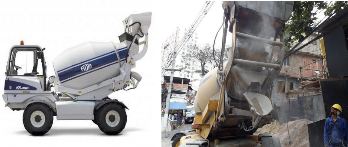
Figura 6: Caminhão betoneira DB460 - FIORI. Fonte: FIORIGROUP e Caminhão betoneira da obra. Fonte: elaborado pelos autores.
