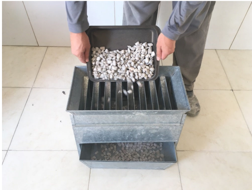
Figura 1: Caracterização do agregado graúdo. Fonte: elaborado pelos autores.
