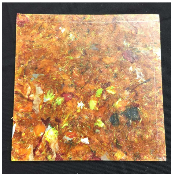
Figura 6: Placa prensada com fibras de coloração laranja. Fonte: elaborado pela autora.
