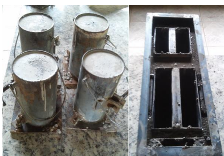
Figura 8. Moldagem dos corpos de prova e do bloco com forma metálica. Fonte: elaborado pelo autor
