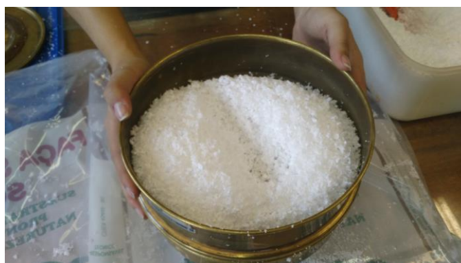
Figura 3: Poliestireno expandido sendo peneirado. Fonte: Elaborado pelos autores.
