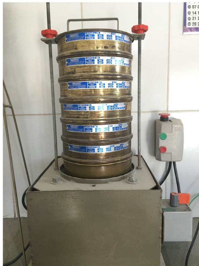
Figura 2: Caracterização do agregado miúdo. Fonte: elaborado pelos autores.
