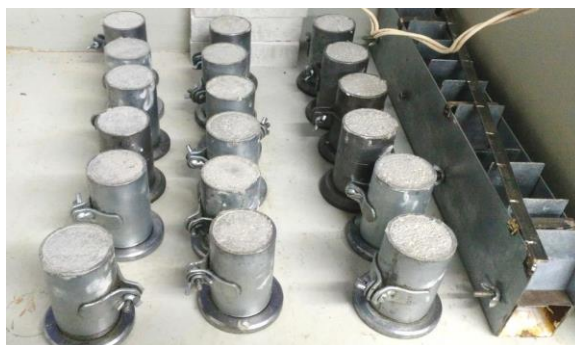
Figura 3: Corpos de prova após a moldagem. Fonte: Elaborado pelos autores.
