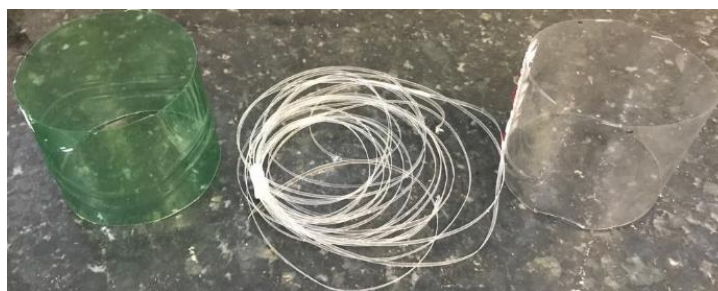
Figura 2: Geocélulas e fio de PET para ligação. Fonte: elaborado pelos autores.
