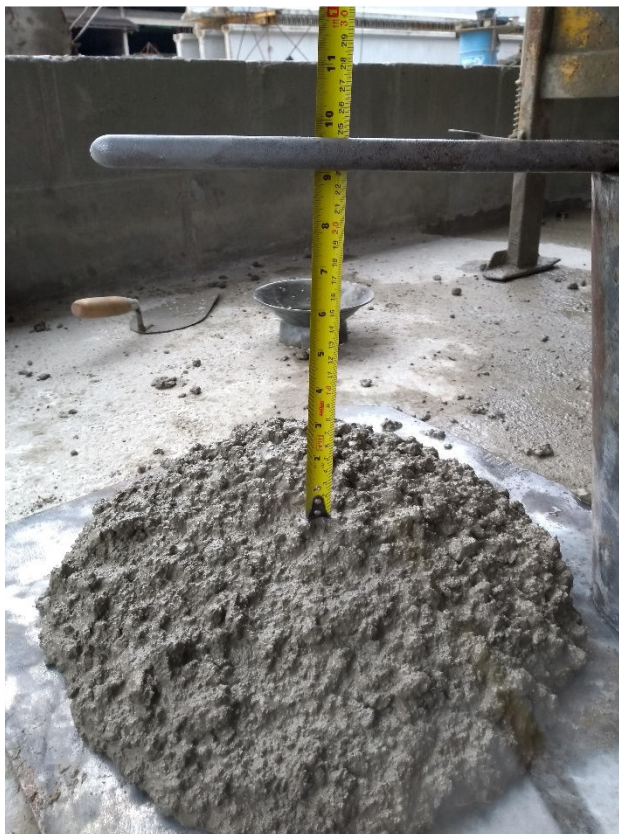
Figura 3: Teste de abatimento do tronco de cone. Fonte: elaborado pelos autores.
