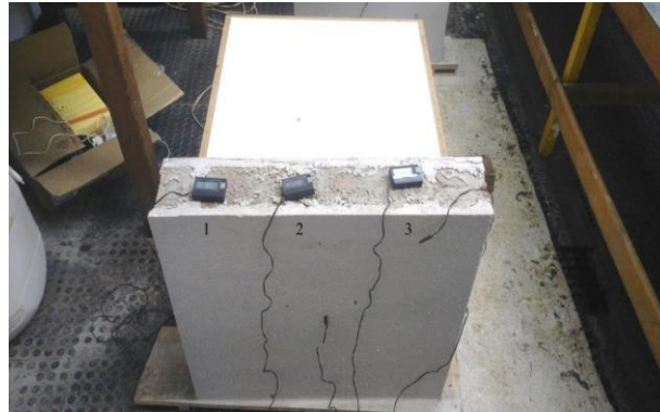
Figura 3: Configuração dos termopares. Fonte: Elaborado pelos autores.
