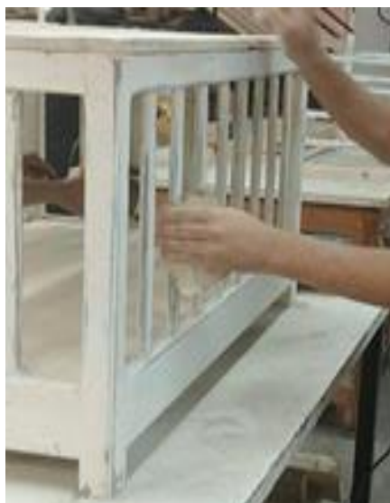
Figura 3: Móvel tv sendo lixado. Fonte: elaborado pelos autores.
