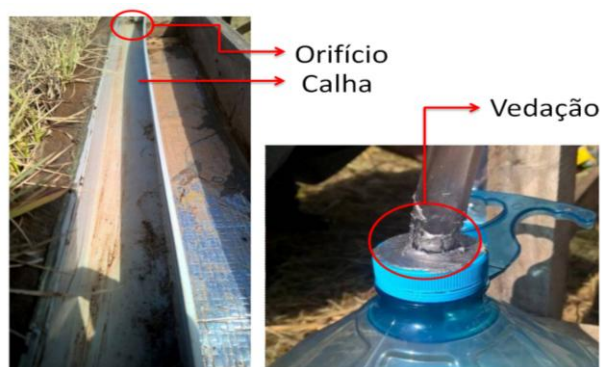
Figura 2-a) Calha coletora b) Equipamento de recepção Fonte: elaborado pelos autores.
