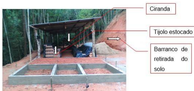
Figura 3: Galpão, ciranda para peneiramento, cura e depósito do tijolo e local da extração do solo
