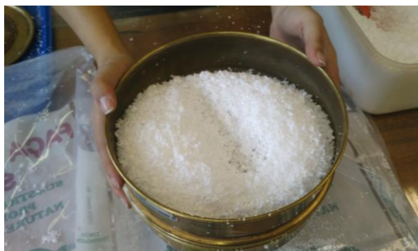
Figura 1: Poliestireno expandido sendo peneirado. Fonte: Elaborado pelos autores.
