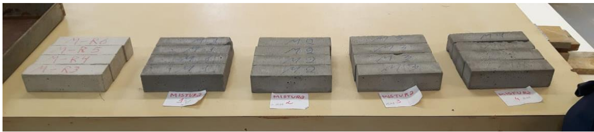
Figura 1: Corpos de prova das misturas. Fonte: elaborado pelos autores.
