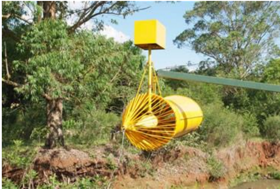
Figura 6: Modelo de balsa com turbina axial totalmente imersa na água. Fonte: Iguazu Energia.
